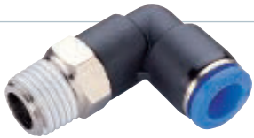
Winkel-Einschraubanschluss, drehbar, mit kegeligem, PTFE-beschichtetem Gewinde
