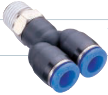
Y-Einschraubanschluss, drehbar, mit kegeligem, PTFE-beschichtetem Gewinde
