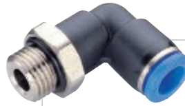
Winkel-Einschraubanschluss, drehbar, mit zylindrischem Gewinde (mit O-Ring)
