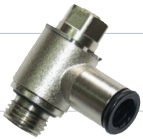
Einschraub-Drosselrückschlagventil, kurze Bauform mit Schlitz Typ A Zuluftdrosselung
