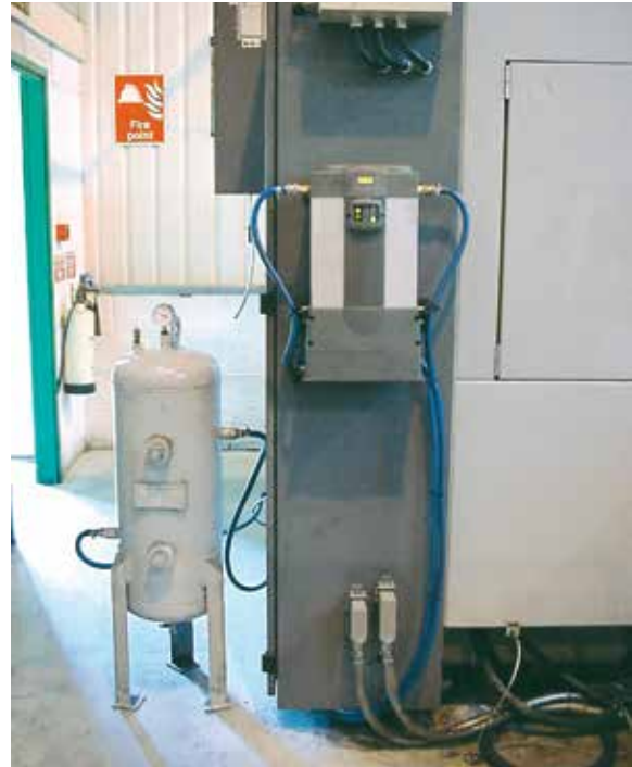
P3TJ Drucklufttrockner für die Steuerluft einer CNC-Drehmaschine
